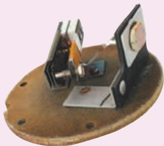
شکل ۲-۲۳ اجزای داخلی یک مدار کنترل کننده نوری، که در نوعی از چراغ‌های روشنایی خیابان‌ها استفاده می‌شود.
