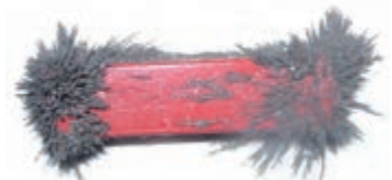
شکل ۳-۳ در آهنربا، دو ناحیه وجود دارد که خاصیت مغناطیسی در آنجا بسیار بیشتر از قسمت‌های دیگر است.
