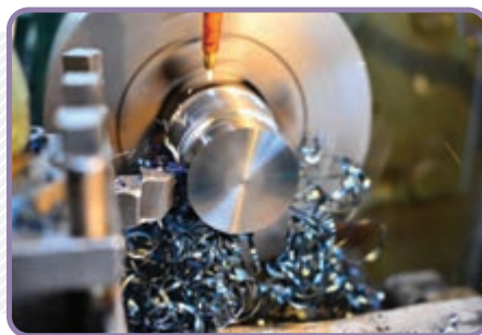
شکل ۲: فرایند ساخت و تولید قطعات به روش حذف مواد اضافی که به شکل براده است، «ماشین‌کاری» نامیده می‌شود.
