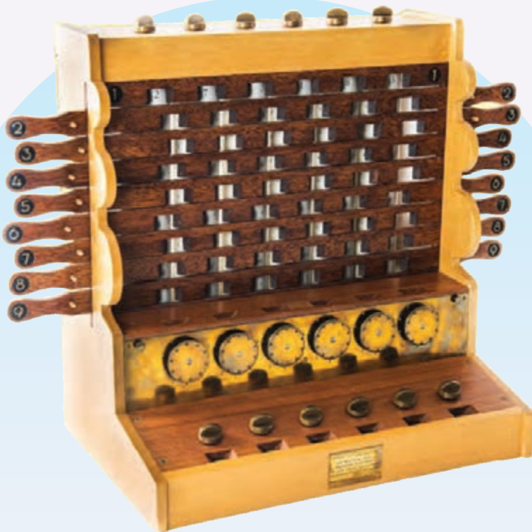
شکل پ ▲ دستگاه محاسباتی شیکارد که بر اساس ابزار جان نپر بازطراحی شده بود.
