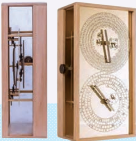
شکل ب ▲ ماشین آنتیکیترا حدود ۲۰۰ سال قبل از میلاد اختراع شد. این ماشین از ۳۷ چرخ دنده تشکیل شده بود.
