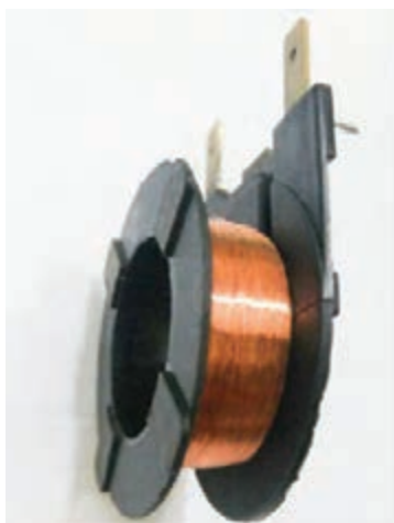
شکل ۲- سیم بیچ داخل موتور
