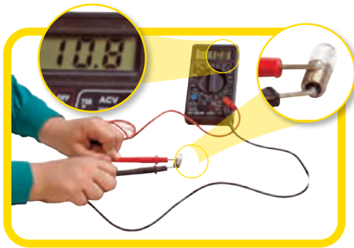
شکل ۸- اندازه‌گیری مقاومت لامپ خاموش با اهم سنج
